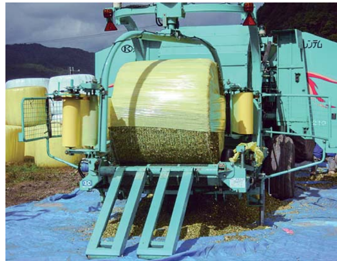
デントコーンのコンビラップ作業。使用後のラップフィルムは廃プラスチックとなります
