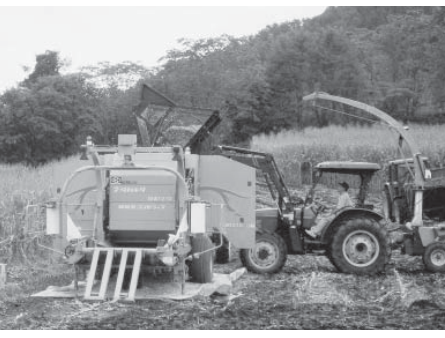
細断したデントコーンを梱包する機械作業の様子
