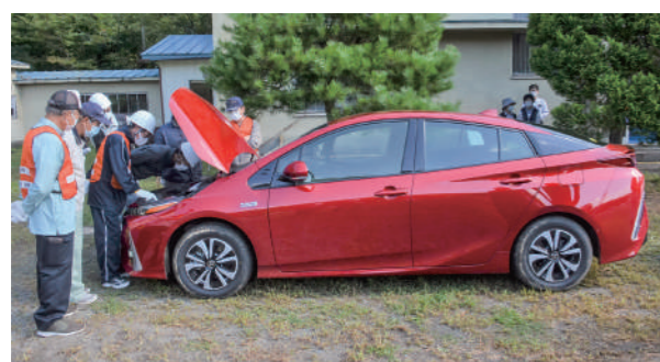
避難所の電源確保のため配備された給電車
