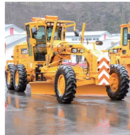
稼働中の除雪ドーザ
