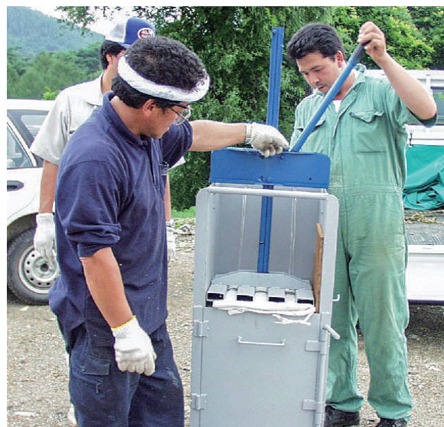
葉タバコ梱包機を改造した器具 廃プラの圧縮ができます
